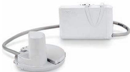
In questa versione il **modulo radio è abbinato all'emettitore di impulsi statico Quadraplus** compatibile con i contatori Maddalena CD ONE e DS TRP predisposti per la trasmissione dati. QuadraPlus è in grado di discriminare la direzione del flusso e assicura un'assoluta insensibilità alle vibrazioni meccaniche. L'utilizzo dei sensori statici abbinati a un microprocessore rende inoltre possibile la gestione degli allarmi relativi a frode e consumo anomalo.
