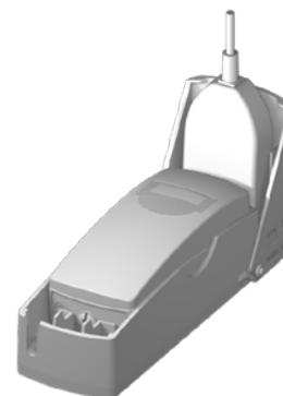
Durante la programmazione occorre premere lo strumento di misura nel supporto (vasca).
